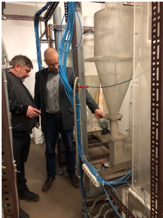
Obrázok 5 Zmenšený plastový model pece v SE-EVO
